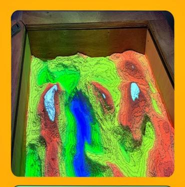
Per far interagire direttamente l'osservatore con l'ambiente 3D, c'è un contenitore dove potete muovere la sabbia cinetica che viene di continuo vivacizzata con la proiezione immediata di nuove curve di livello sulla superficie creata da voi, mentre fasce di colori differenti esaltano le variazioni di quota man mano che voi modellate la superficie!
